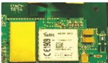
图6. 组装的混合天线原型
