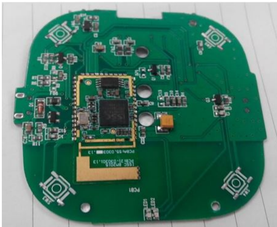
图示 8-大联大品佳推出的基于 Microchip 的蓝牙灯智能调光板照片
